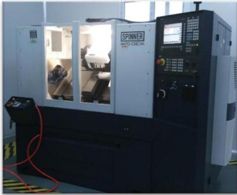
用途：同时具有车功能和铣功能，能够在一次装夹中同时完成车铣加工，避免了因二次装夹引起的误差，同时提高了加工效率。该机床从德国进口，SEIMENS 系统，单主轴。可用于回转类零件的车铣一体加工。
