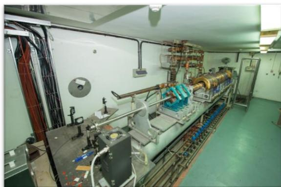
用途：主要用于快速反应动力学研究，探测化学反应中间产物，研究产物的化学反应过程和动力学行为。如研究电子束诱导产生的水合电子、羟基自由基等中间产物的生成及与其他目标化合物反应的瞬态过程。主要用来探测 0.1~50 微秒范围内所产生的离子、自由基等中间产物及其生成和衰变过程的动力学行为。
