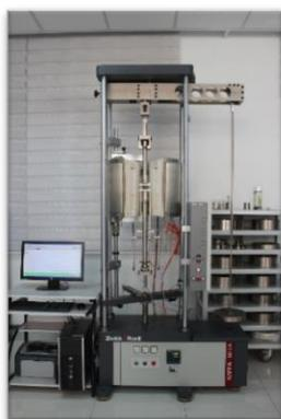
用途：测试金属材料的蠕变性能和持久寿命。
