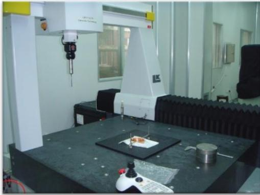
用途：测量各种几何尺寸、形位公差等。英国进口。使用 CAMIO 软件编程。工业陶瓷级别三轴非金属材料，X 轴采用法国阿尔卑斯山区的特种花岗岩，三轴滚动摩擦传动，配有主动气浮减震系统。
