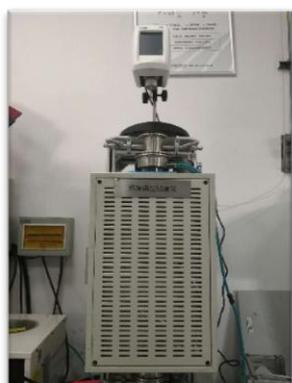
用途：采用旋转法测量高温熔盐粘度。仪器操作简单，测试精度高，稳定性好，样品用量只需 50-60 ml，是国内为数不多的能满足高温熔盐的低粘度测试需要的设备。可为太阳能集热、工业余热回收、高温传蓄热、新型熔盐研发等领域用熔盐提供关键粘度数据。
