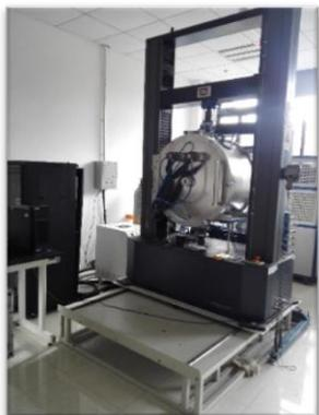
用途：仪器由高温真空炉、冷却系统、气炉系统、万能试验机等构成。可进行惰性气氛下材料力学强度测试，包括抗折强度、抗压强度、抗拉强度、断裂韧性等。
