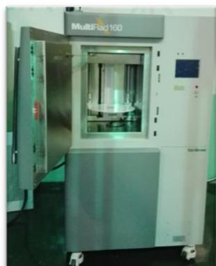
用途：在自屏蔽箱体内部，通过 10-160kV 高能 X 射线对有机无机纤维、薄膜、纳米材料，表面界面材料等样本进行照射。
