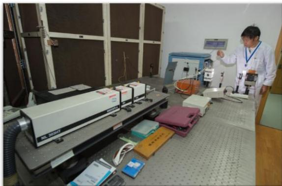
用途：主要用来探测 0.1~50 微秒范围内所产生的激发态、离子、自由基等中间产物及其生成和衰变过程的动力学行为。可用于：（1）光合作用中电子和能量的快速转移过程。（2）光敏剂的光诱导过程及作用机理。（3）生物大分子的光敏损伤过程和机理。（4）工业废水、环境垃圾等光降解行为和过程研究等。
