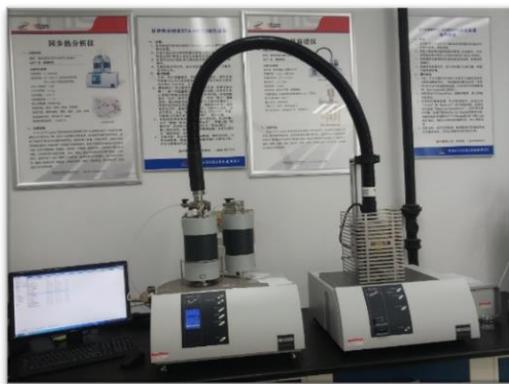
用途：对材料的热稳定性，分解行为，组分分析，相转变，熔融过程等进行表征及比热测试，同时还可以对逸出气体进行鉴别和定量分析。广泛应用于陶瓷、玻璃、金属/合金、矿物、催化剂、含能材料、塑胶高分子、涂料、医药、食品等各种领域。
