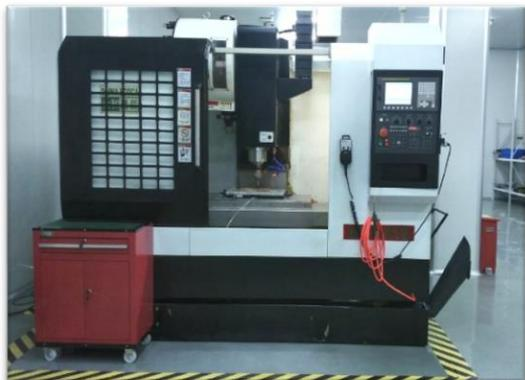
用途：数控加工中心，即带有自动换刀功能的数控铣床。本台加工中心从台湾进口，使用 FANUC 系统，用计算机编程三轴联动，能够加工各种平面直壁零件以及复杂的曲面零件。主要用于高精度铣削加工、钻孔加工等。
