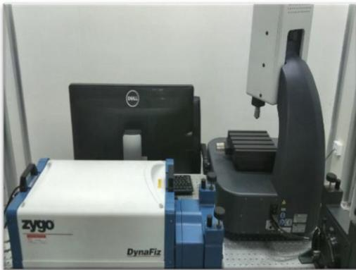
用途：测量各种材料的面形，提供各种参数，包括表面结构，面形和台阶高度等等的 2D 和 3D 图形。
