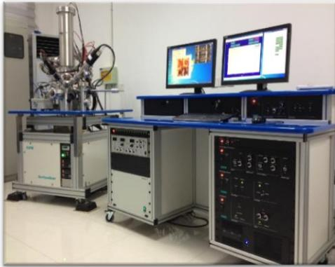
用途：固体表面无机全元素和 1-3000 有机物质谱分析以及痕量元素/有机物定量，二次离子成像，痕量元素深度分布分析
