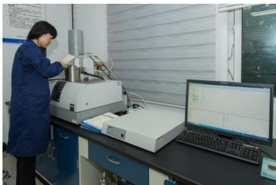
用途：测量固体或液体材料的热扩散系数、导热系数、比热等。广泛应用于各种工业材料、
