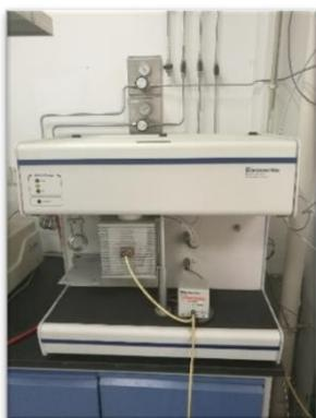
用途：可以实现对催化材料进行程序升温还原（TPR）、氧化（TPO）、脱附（TPD）以及脉冲吸附（Pulse）等的表征，能够检测出材料的氧化还原性质和金属的分散度等。
