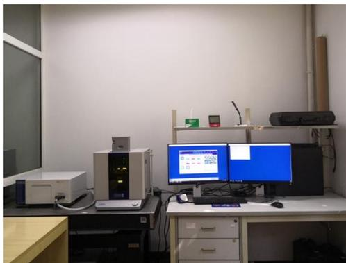
用途：扫描探针显微镜系统是国际上材料微纳结构检测和分析的先进科研设备。它可以在纳米尺度上实现对样品表面形貌、力学、电学、摩擦学和粘性等多种物理性质的同步检测，具有分辨率高、操控精确的特点，可以对材料开展三维形貌、晶体结构、力学、电学及磁学性质等的微区定性\定量分析研究，并且具有强大的微纳尺度加工能力。
