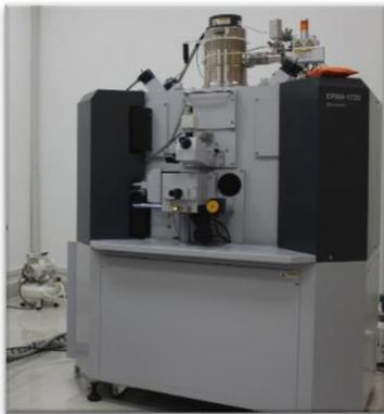
用途：电子探针将扫描电子显微镜和波谱仪结合，在显微镜下把观察到的显微组织和元素成分联系起来，解决材料显微不均匀性的问题。形貌分析，波谱定性分析，波谱定量分析，状态分析。
