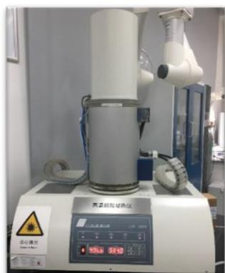
用途：高温导热仪需要采用激光闪烁法测量样品的导热系数。具有测试范围广，可以同时测量多个样品，测量精度高等诸多优点。
