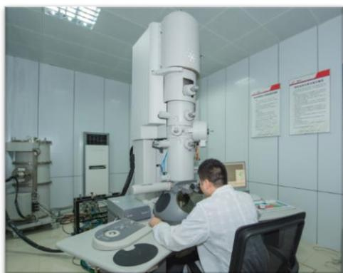
**用途：** 主要应用于对无机材料的内部微观结构分析，配合能谱仪可以对微区进行定性及半定量的成分分析。具体功能包括选区衍射、微束衍射、会聚束衍射、衍衬像（明、暗场像）、低倍形貌像、高分辨像 (HRTEM)、高角环形暗场像 (Z-衬度像) 以及元素的点、线和面分析。
