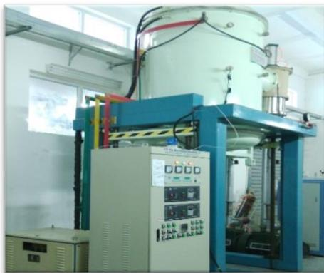
用途：炉底升降式真空钎焊炉，主要由真空系统、加热系统和冷却系统组成。采用 2 级真空机组，包括两台机械泵和两台分子泵。用于高真空钎焊、热处理、除气、去磁等。
