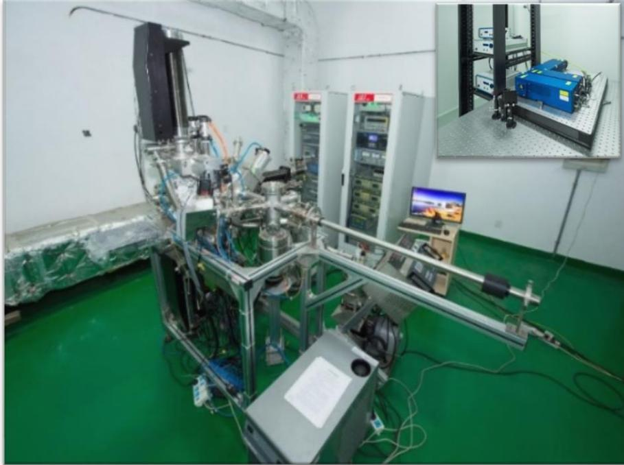
用途：主要用于产生低发射度、皮秒级快速响应的高平均功率的电子束团。
