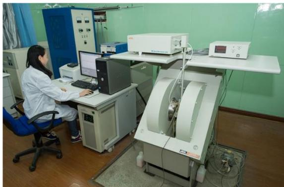
用途：电子自旋共振谱仪是测定固体，液体，气体等物质中未成对电子的电子自旋共振现象的仪器。1、物理领域：研究含有未成对电子的原子，离子，分子；研究金属或半导体中的传导电子；研究晶体缺陷，辐照效应和辐照损伤；研究半导体中掺杂的影响；研究半晶中的晶场；及材料的磁性研究等。2、化学领域：三重态的自由基和分子的研究；反应动力学的研究；聚合物的研究；光化学和辐照产生的自由基研究；g 射线照射产生的有机自由基的短暂行为研究等。3、生物与医学领域：有机生物细胞组织中的自由基研究；生物化合物的 x 射线效应研究；药物检测，辐照食品的控制研究；致癌物反应的研究及血液和微生物的研究。4、其他：地质和考古样品的年代测定及研究；辐照剂量学研究；丙氨酸/ESR 剂量测定等。主要技术指标：灵敏度：7\*10<sup>9</sup>/10-4T；分辨率：2.35μT；微波频率：8750-9650MHz (X-band)；微波功率：0.1μW-200mW；最大磁感应强度：1.3T。
