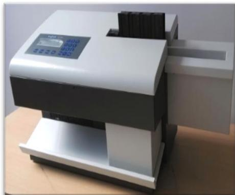
用途：RE2000A 全自动热释光剂量计读出器是于 2008 引进的由芬兰 RADOS 公司生产的全自动热释光读数系统，系统于 2015 年 10 月进行了升级改造，由半自动测读系统升级为全自动剂量测读系统，使连续测量能力大幅提高。可为医院放射诊断和治疗、工业探伤、口腔诊所，核电站等放射工作人员提供 X、 $\gamma$ 和中子个人剂量监测服务。
