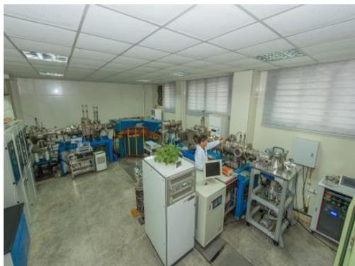
用途：本仪器既可作为一台同位素分离器，也可用作一台离子注入装置。可开展离子溅射研究，离子注入材料改性、纳米材料研究、离子束辐照损伤研究、摩斯鲍尔样品制备等测试服务。
