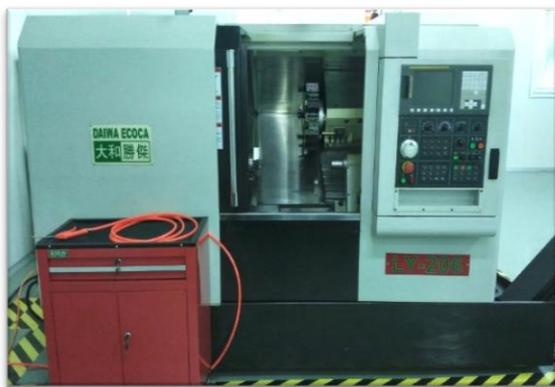
用途：该数控车床从台湾进口，具有自动换刀功能，配备转塔式刀库，FANUC 系统。主要用于高精度车削加工。
