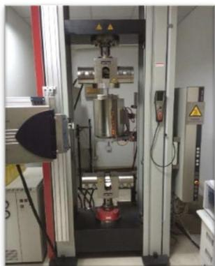
用途：250KN 万能电子试验机是主要适用于金属、非金属、复合材料的拉伸、压缩、弯曲、撕裂等试验，可进行常温以及低温、高温环境下的测试。该设备为国际先进的力学性能测试设备。
