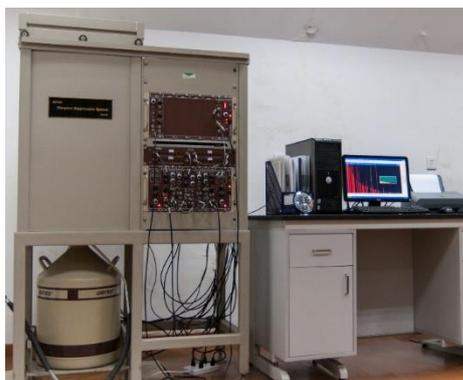
用途：MX-50 伽玛能谱仪采用了高纯锗半导体探头做为测量主探头，碘化钠探头做为反康探头。它通过探测放射性核素发射出来各种能量的伽玛粒子，对放射性核素进行定性，定量分析。广泛用于核设施和环境监测，样品示踪，进出口商品检测等领域
