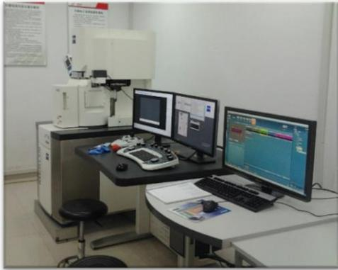
用途：主要用于分析材料的显微结构及成分。二次电子像：高分辨率的样品表面形貌成像；背散射电子像：表面形貌成像，原子序数衬度成像；电子背散射衍射：电子通道花样，晶体取向 位向差分析，织构分析，相鉴定；能谱分析：材料微区成分元素种类与含量分析。
