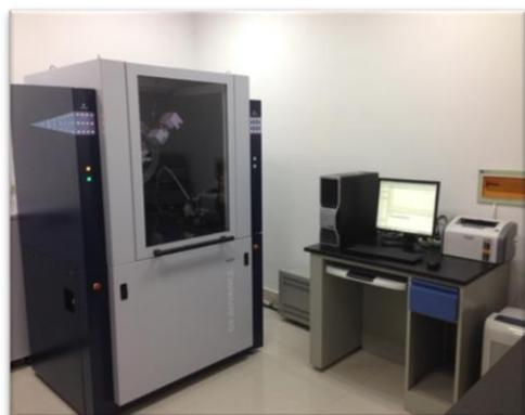
**用途：**利用 X 射线衍射原理研究物质内部微观结构。具有不损伤样品、无污染、快捷、测量精度高、能得到有关晶体完整性的大量信息等优点。主要功能包括：粉末衍射、掠入射衍射、晶胞参数测定和修正、织构测试、高温 XRD 等。
