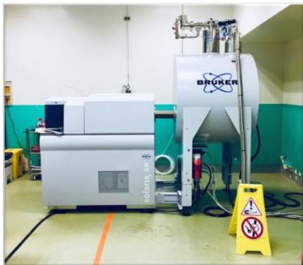
用途：具有超高的质量准确度和分辨率；可根据给定磁场中的离子回旋频率来测量离子质荷比(m/z)的质谱仪。小分子分析；高级蛋白质分析；分子成像；复杂混合物分析；金属离子配合物的气相化学行为等。
