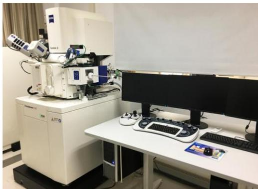
**用途：** a) 高分辨二次电子图像； b) 高分辨背散射电子图像； c) 三维重构成像； d) 三维空间材料组成及分布； e) 三维孔隙分布、连通性、孔径及孔隙度； f) 元素组成与含量(EDS)分析； g) 透射电镜样品制备； h) 纳米加工(沉积、刻蚀)。
