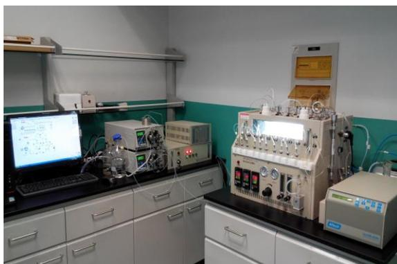
用途：用于 F-18 等发射正电子短寿命的放射性核素标记合成各类有机化合物的设备。
