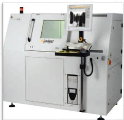
用途：高分辨率的微焦点 X 射线检测系统，可用于焊点和电子元件的实时 X 射线检测，也可用于微小样品的内部结构的微观检测。具有高放大倍率，精确的操作，高度的可再现性等优势。180 千伏/ 20 瓦的高功率微焦点管，可进行达 0.5 微米的细节探测。
