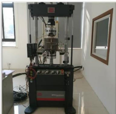
用途：电液伺服 MTS 低周疲劳试验机，用于金属材料疲劳试验，可用于室温和高温试验。
