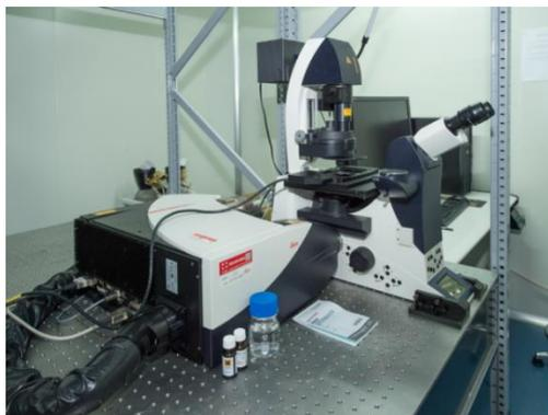
用途：在传统光学显微镜基础上，激光扫描共聚焦显微镜用激光作为光源，采用共轭聚焦原理和装置，逐点、逐行、逐面快速扫描成像，并利用计算机对所观察的对象进行数字图像处理观察、分析和输出，其特点是可以对样品进行断层扫描和成像，进行无损伤观察和分析细胞的三维空间结构。主要功能包括：序列成像（细胞中纳米材料与亚细胞器的共定位）和长时间成像（长时间（大于 2 小时）原位观测纳米材料进入细胞的过程）。
